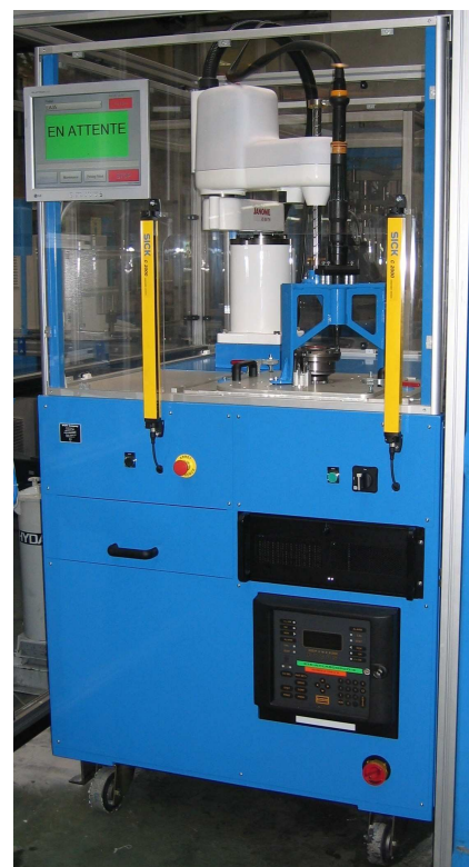
Le poste complet avec son écran tactile et sa barrière immatérielle de sécurité.
