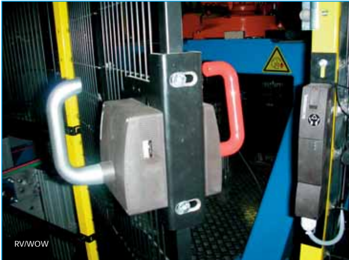
Le système d'interverrouillage AZM-200 de Schmersal à redondance incorporée (catégorie 4 selon EN 954-1, SIL3 selon IEC 61508) a été utilisé dans cette application-ci pour sa simplicité de montage.
