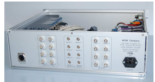
Tout le système d'acquisition, de régulation (boucle PID) et de pilotage des vérins est intégré dans un rack industriel 19"/ 3U.
