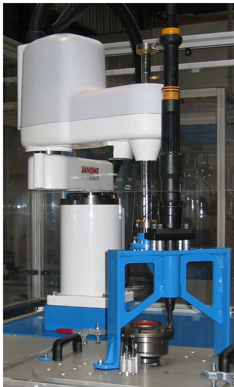
Vue du robot, de la visseuse, du bras de reprise de couple et du différentiel
