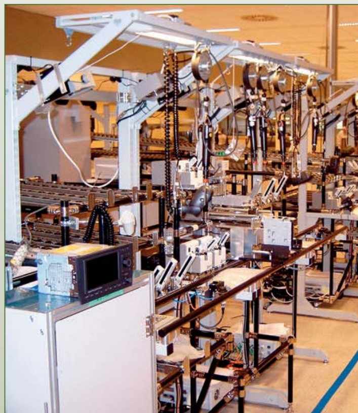
Le système 'foolproof' supervise étape par étape les opérations réalisées manuellement à un poste de travail.
