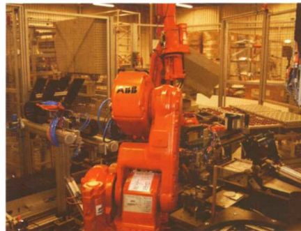
Ligne de production (assemblage et tests en ligne) de matériel industriel, automatisée et robotisée.
